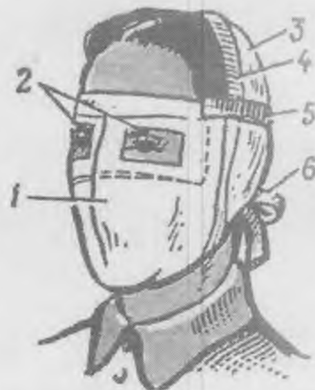
Рис. Протипилова тканинна маска ПТМ-1: 1 – корпус маски; 2 – оглядові отвори; 3 – кріплення; 4 – гумова тасьма; 5 – поперечна гумова смужка; 6 – зав'язки.
